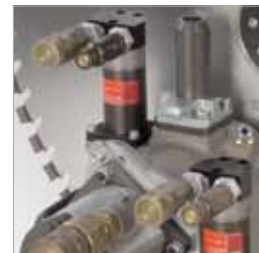
Надёжная режущая голова со стандартными гидравлическими моторами
