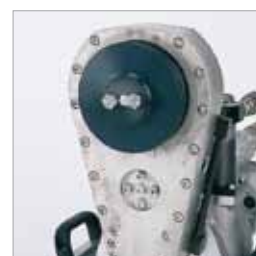
Поворотная рука с быстросъемным фланцем для легкой замены диска
