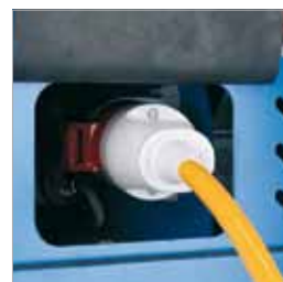
Защита от брызг входа силового кабеля в корпус машины
