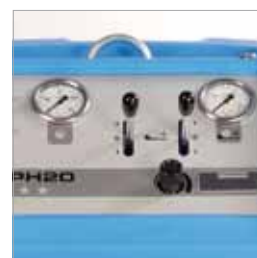
Манометры для главного контура и контура управления на панели
